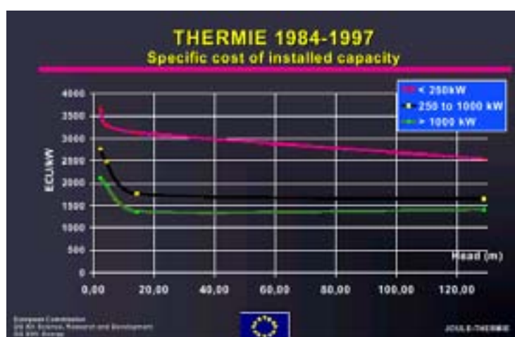
Figura 8.1: Costo specifico per capacità installata
